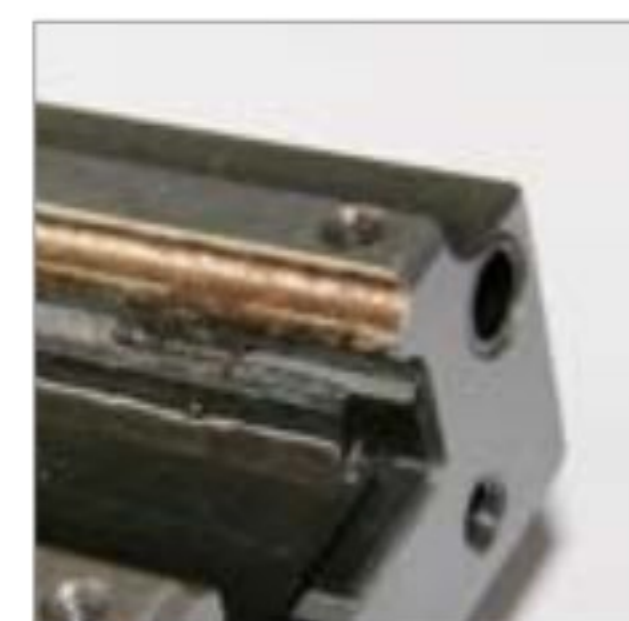
潤滑油乾涸殘留物 上儲油塊破損
