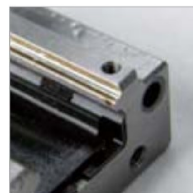
上儲油塊完好 供油正常 軌道面正常
