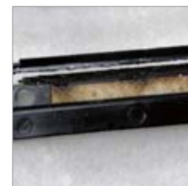
潤滑油乾涸殘留物 下儲油塊破損
